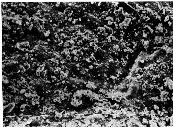
Ryc. 1. Zdjęcie z mikroskopu skaningowego górnej powierzchni liścia Alnus sp. z otoczenia huty oraz elektrowni opalanej węglem. Pyły o kształcie kulistym są najprawdopodobniej pyłami z elektrowni (analiza EDAX wykazała obecność Al i Si jako głównych komponentów). Każdy odcinek linii = 10 \mu\text{m}
