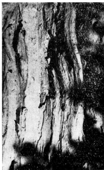
Ryc. 2. Pomiędzy zniszczonymi słojami widoczne są duże płyty grzybni
